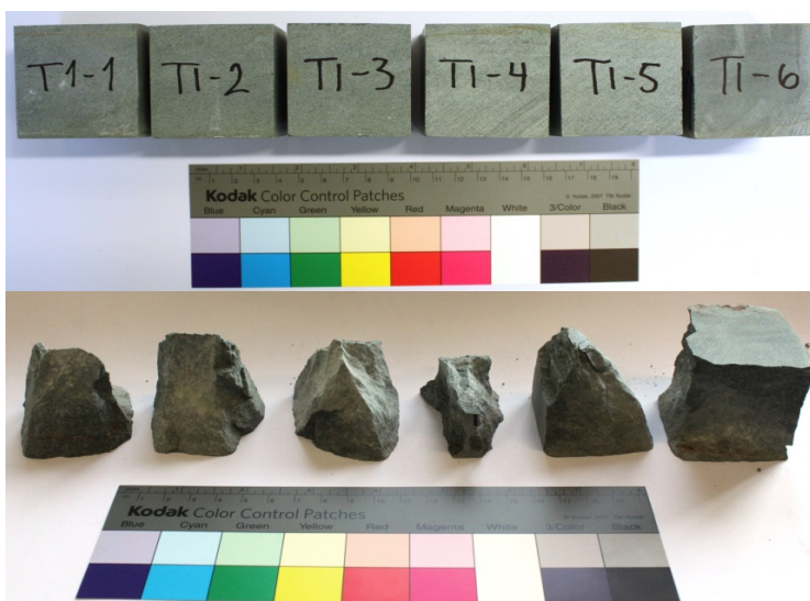
Bilder av prøver for måling av trykkfasthet før (øverst) og etter (nederst) prøving.
